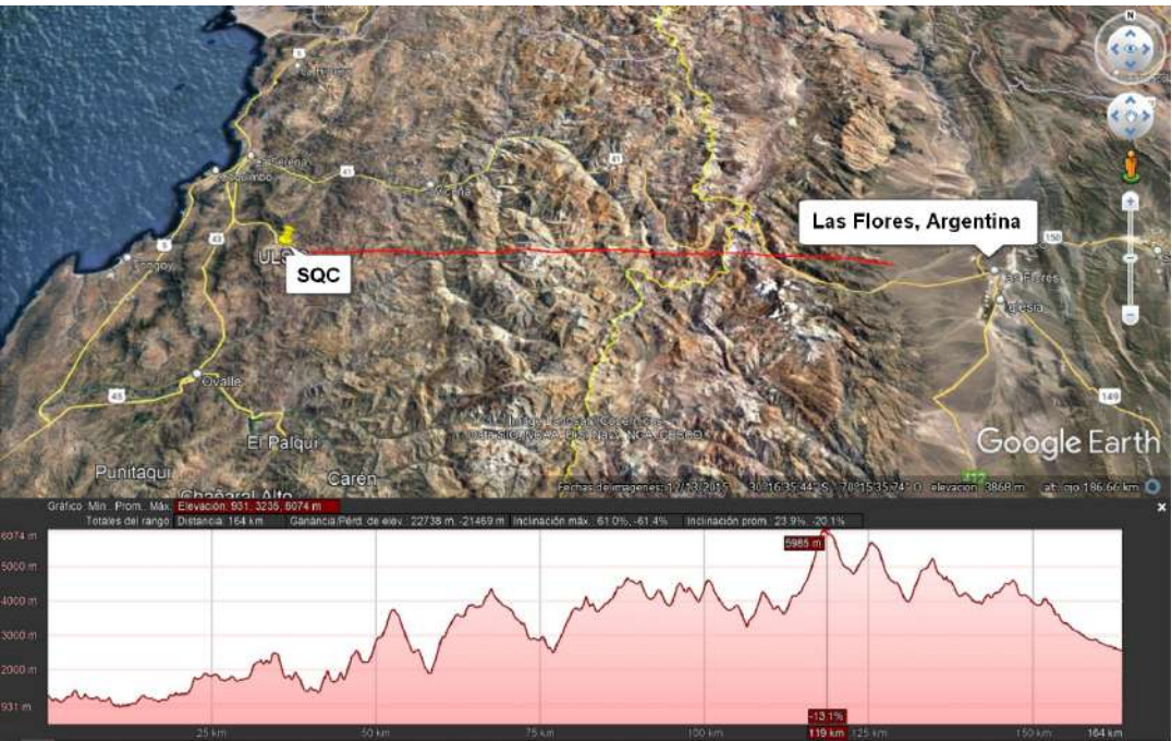
FIGURA 7.13: Perfil de elevación para el azimut central (91°) de la zona Clean Direction obtenido a partir de Google Earth. En el eje x del gráfico se tiene la distancia en kilómetros, y el eje y representa la altura en metros.
