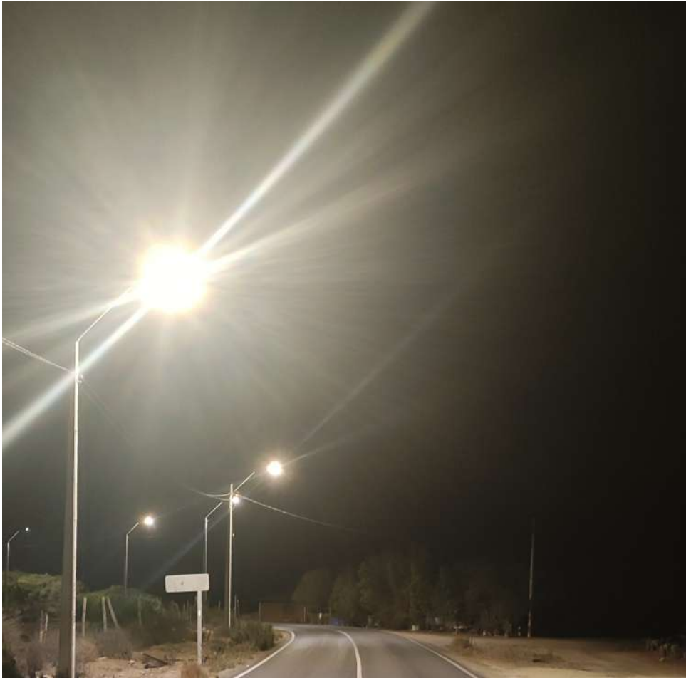
FIGURA 3.5: Ejemplo práctico del fenómeno de discomfort glare en las luminarias públicas instaladas en Tambillos (lugar de residencia del autor de esta tesis), un pueblo de la Región de Coquimbo.
