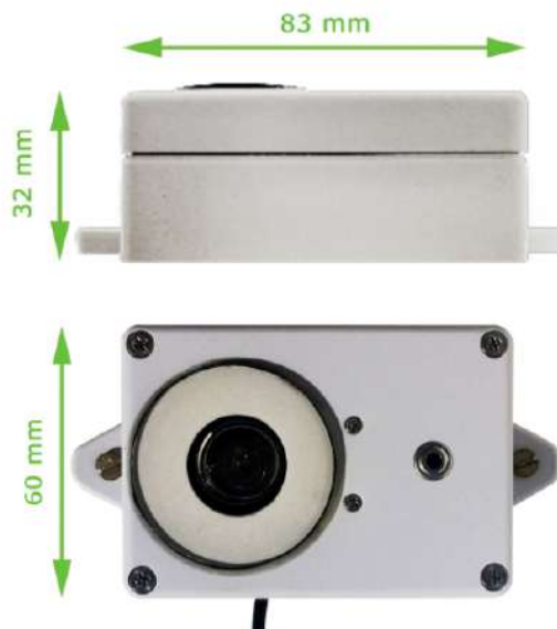
Figura 3.10: Dimensiones de los fotómetros TAS.
