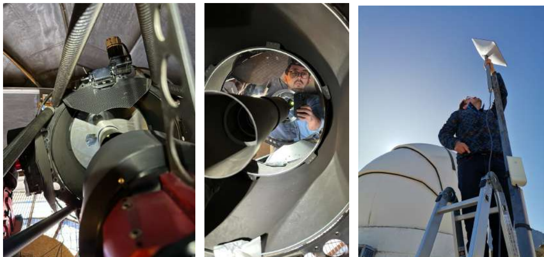
Figura 4.1: Izquierda: Espejo primario telescopio FALCON-ULS meses después de la pandemia del Covid-19. Centro: El primario de 20” pulgadas luego de un mantenimiento para mejorar su reflectividad. Derecha: Pablo instalando una antena de conectividad a internet en las instalaciones de FALCON-ULS. Foto por José Luis Nilo Castellón.
