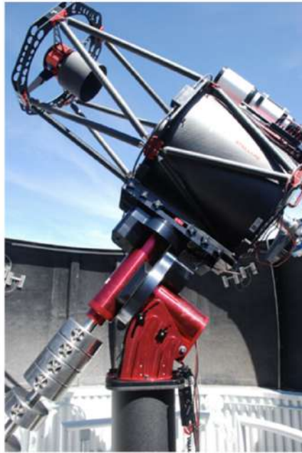
Figura 3.3: Figura extraída de Chun et al. (2018). Una de las unidades FTN, específicamente en Fort Lewis College, en Durango-Colorado. Un ejemplo de cómo se ve el sistema después de la instalación. Se pueden apreciar componentes como la montura ecuatorial, el anillo que soporta el secundario y los contrapesos.
